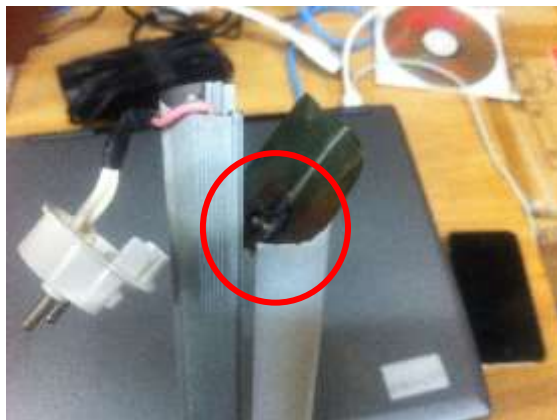
焼損した LED 型蛍光灯の電源回路部
